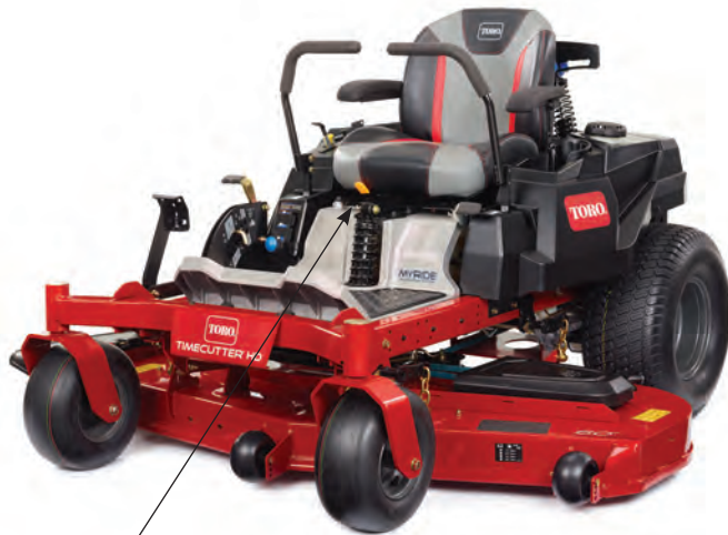
En avfjæret plattform – MyRide Suspension System Toros nye MyRide Suspension System. En avfjæret plattform med justerbare fjærer gir en forbedret kjøreeplevelse.
