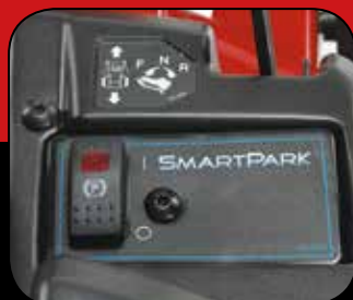
SMART PARK™ Toros unike automatiske håndbrems-system gjør så knivene stanser når du går av klipperen, uten at motoren stopper.
