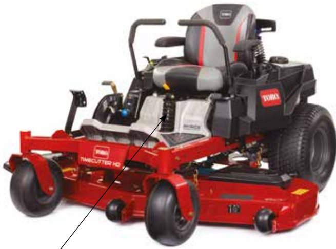
En avfjæret plattform – MyRide Suspension System Toros nye MyRide Suspension System. En avfjæret plattform med justerbare fjærer gir en forbedret kjøreepplevelse.
