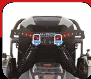
MY-RIDE SUSPENSION SYSTEM Toros nye MyRide Suspension System. En avfjæret plattform med justerbare fjærer gir en forbedret kjøreepplevelse.
