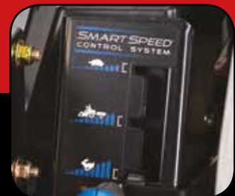
SMART SPEED™ Toro TimeCutter HDXS er utstyrt med den praktiske innovasjonen Smart Speed der du selv bestemmer hvilken hastighet du vil klippe. Hastigheten stilles i tre ulike nivåer. Velg mellom klipping av store overflater, treimming rundt trær/busker eller transport.
