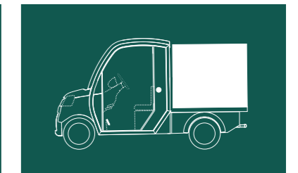
1,4 m³ closed vanbox L. 1284 x B. 1223 x H. 1100 mm
