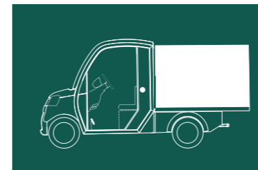
2,1 m³ closed vanbox L. 1550 x B. 1250 x H. 1100 mm
