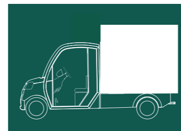
3,1 m³ closed vanbox L. 2050 x B. 1250 x H. 1600 mm 4,1 m³ closed vanbox L. 2050 x B. 1250 x H. 1600 mm
