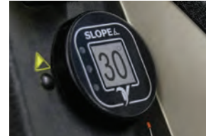
DIGITAL SLÄNT INDIKATOR Visar lutningsgraden när traktorn är i drift.
