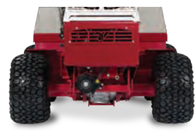
HJULBREDDARE Öka stabiliteten i sluttningar upp till 25°.
