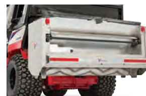
5A250 FALLSPRIDARE 2.5 ft³/200lbs kapacitet
